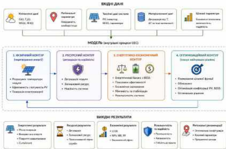
Рисунок 1 – Структура регіонально-адаптивної моделі функціонування фотоелектричної системи
