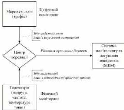
Рисунок 2 – Концептуальна модель крос-доменного моніторингу стану мікромережі
