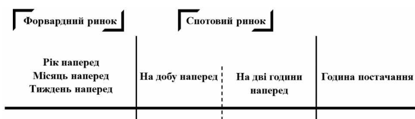
Рисунок 6. Часові межі укладання угод на різних сегментах ринку електричної енергії
