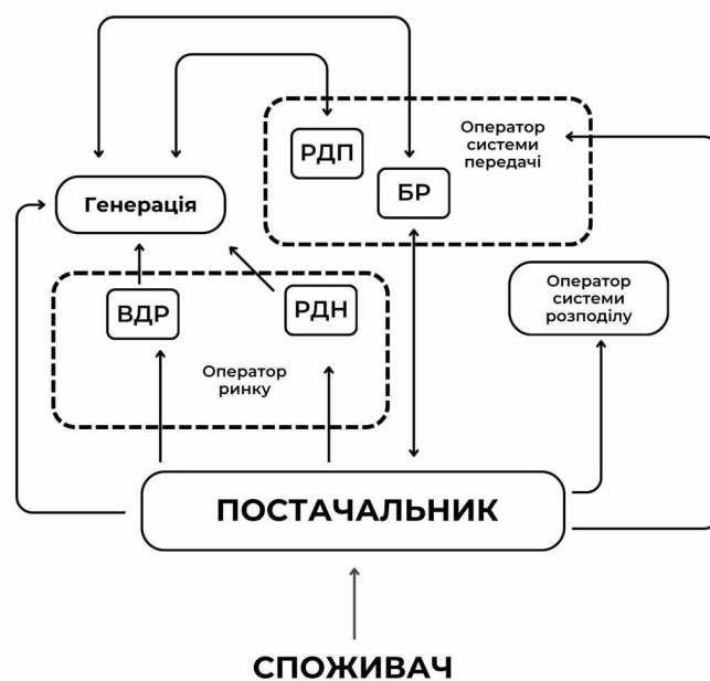
Рисунок 2. Взаємодія постачальника з іншими учасниками ринку електричної енергії: РДН — ринок «на добу наперед»; ВДР — внутрішньодобовий ринок; БР — балансуючий ринок; РДП — ринок допоміжних послуг.
