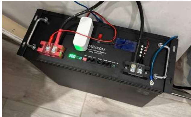
Рисунок 3. – Приклад підключення віддаленого сенсору напруги
