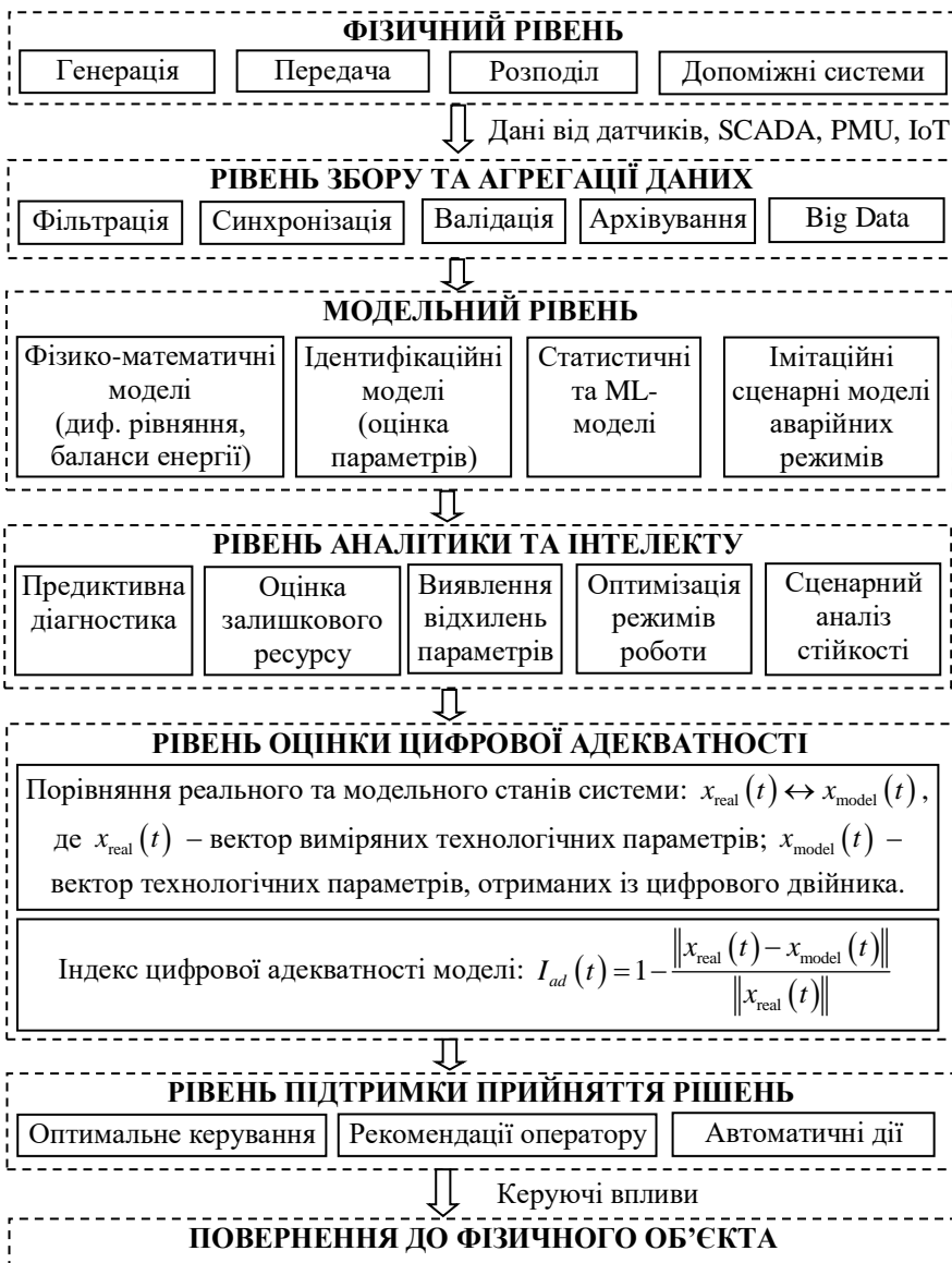
Рисунок 1. – Багаторівнева кіберфізична архітектура цифрового двійника енергетичного об'єкта з контуром адаптивної ідентифікації
