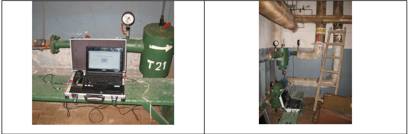
Рисунок 1 – Реєстратор системи РАСТР-2В під час випробувань у бойлері
