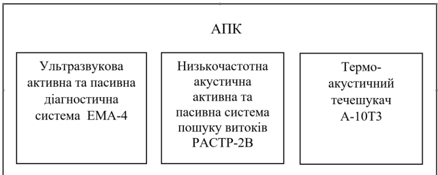
Рисунок 1 – Структура АПК виявлення пошкоджень трубопроводів
