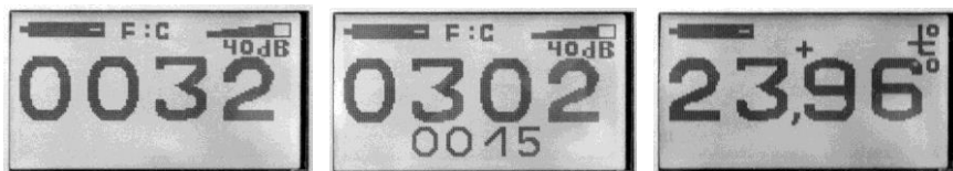
Рисунок 2 – Індикація результатів вимірювання рівнів акустичних сигналів та температури течешукачем А-10Т3. 40 дБ – єдине додаткове кероване посилення сигналів в датчику
