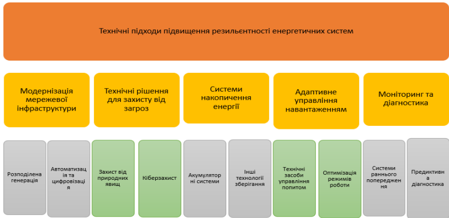
Рисунок 2 – Класифікація технічних методів підвищення резильєнтності енергетичних систем
