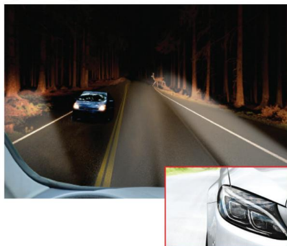
Рисунок 3 – Порівняння традиційної та адаптивної систем фронтального освітлення автомобільних фар
