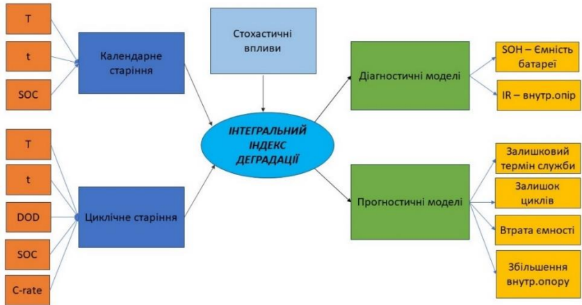
Рисунок 2 – Діагностичні та прогностичні моделі вторинного використання ЛІБ електротранспорту [10]
