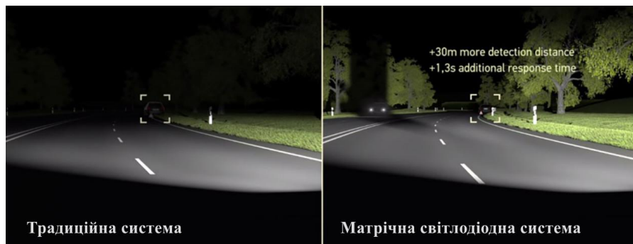
Рисунок 4 – Порівняння традиційної та матричної світлодіодної системи фронтального освітлення автомобільних фар
