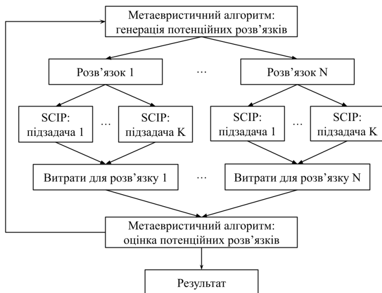
Рисунок 1 – Узагальнений алгоритм розв’язування задачі MILP з використанням метаевристичного алгоритму та солвера SCIP
