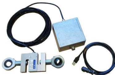
Рис.1. Тензодатчик та інтерфейсний блок силовимірювальної системи "МАНЕКЕН 1.03"
