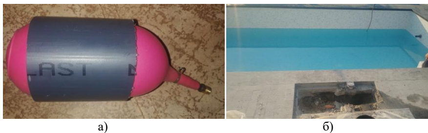
Рис.1 Виготовлена пневматична заглушка для діаметру 50 мм (а) та місце монтажу (б)
