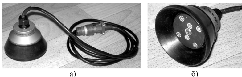
Рисунок 4 – Безконтактний датчик теплового випромінювання ІКДТ-2. а) загальний вигляд; б) вигляд із боку чутливого елемента
