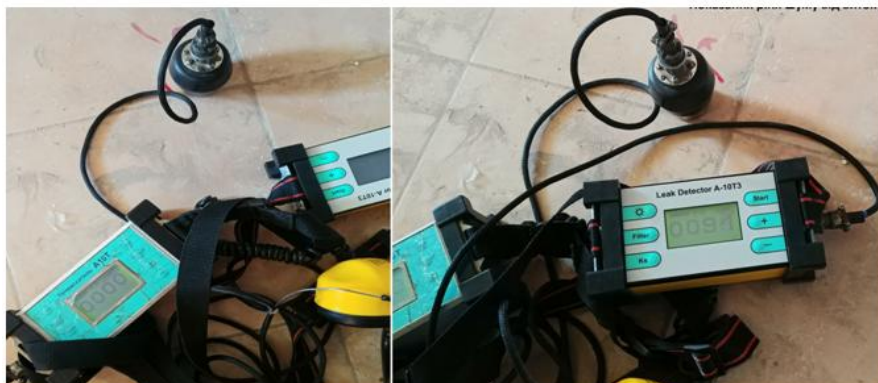
Рис.2. Різниця результатів вимірювання рівня шуму течешукачами А-10 і А10Т3
