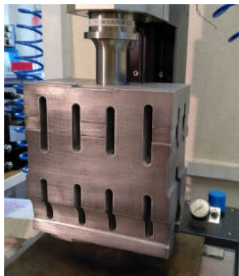
Рисунок 3 – Фото виготовленого складного сонотроду
