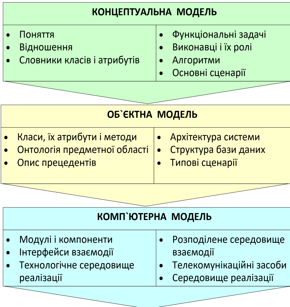
Рисунок 1.10 – Багаторівнева інтегрована модель програмних систем
