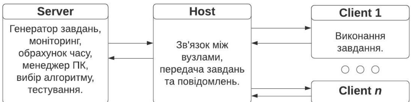
Рисунок 4 – Схема компонентів симулятора GRID-системи та їх основні функції
