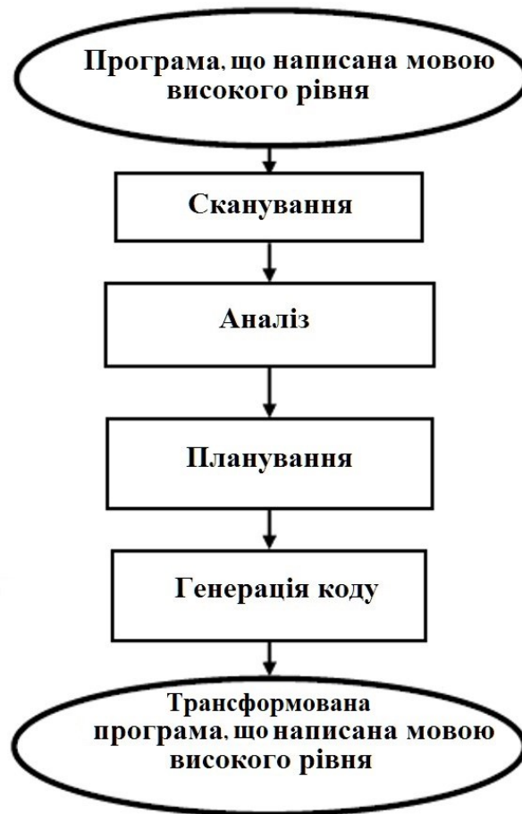
Рисунок 1.3 – Загальна блок-схема процесу розпаралелювання програм мовою високого рівня
