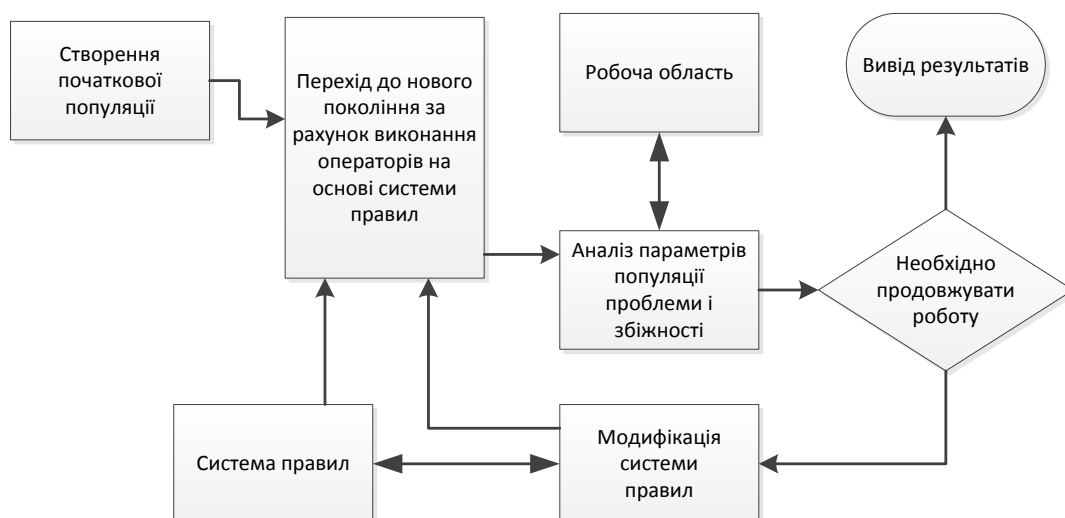
Рис. 4.14. Схема роботи генетичного алгоритму
