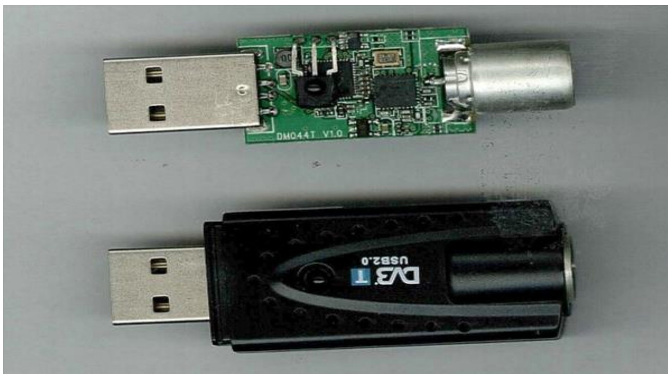
Рисунок 4.1– SDR-приймач з полосою прийому радіосигналу 25-1750 МГц.
