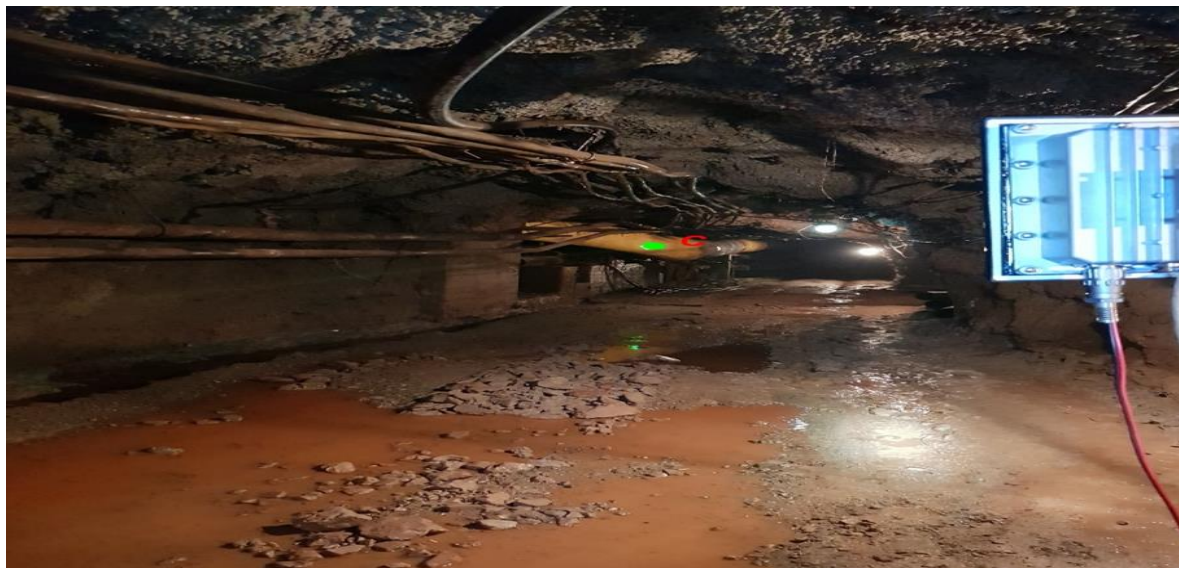
Рисунок 2.4 – Приклад розміщення антенні радіопристрою в шахті, С -точка падіння прямого радіопромменя на відстані 30 м.
