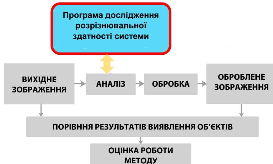
Рис. 4.1 Спрощена схема роботи системи аналізу та обробки зображень
