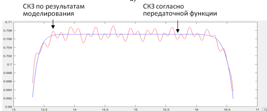
Рис.1. Сравнение частотных характеристик СКЗ на выходе фильтра согласно передаточной функции и согласно результату численного моделирования в диапазоне частот 3 ... 30 Гц (а) и в полосе пропускания - 13,31 ... 16,62 Гц (б).
