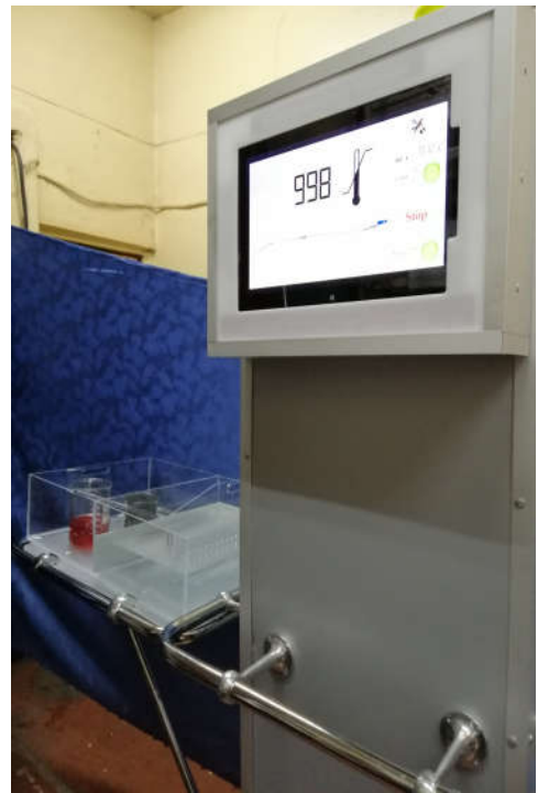
Рис. 1. а) 3D-модель установки: 1 – реактор, 2 – вузол дозування, 3 – вузол відвантаження, 4 – лоток, 5 – блок управління, 6 – реле включення нагріву, 7 – компресор, 8 – вентилятор-равлик, 9 – контролер; б) фотографія установки
