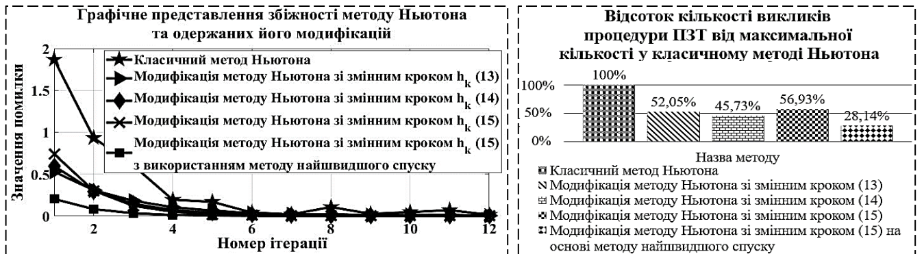
Рис. 7 – Порівняльний аналіз роботи алгоритмів за критерієм збіжності (зліва) та критерієм кількості обчислювальних затрат з розкладом граничної умови в ряд (справа)
