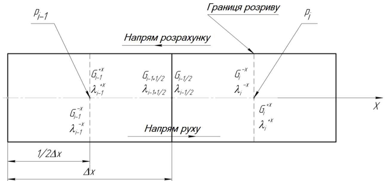
Рис. 4.3. Розрахункова схема для визначення параметрів повітря на границях елементів.
