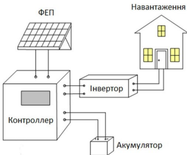
Рис. 1. Приклад автономної системи енергопостачання
